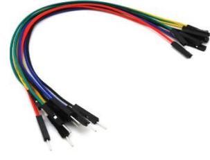
Figuur 16: male-to-female jumper wires waarbij één uiteinde een pin bevat en het andere uiteinde een gaatje).
