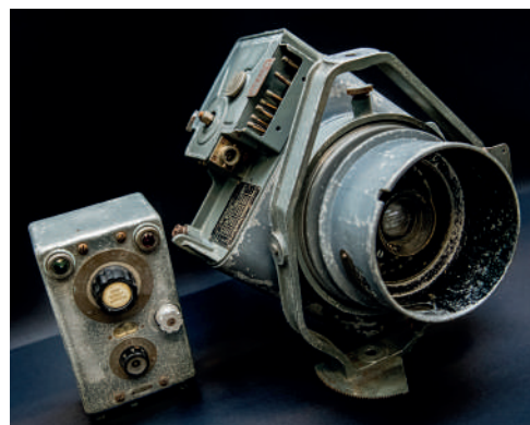
▲ Luchtfotocamera met timing-motor
